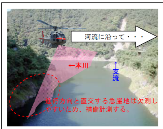
図 4.2-4 航空レーザー計測イメージ
