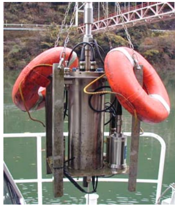
図 5.2-5(2) 大峰橋地点水質自動観測装置(操作盤・センサー部・立面図)
