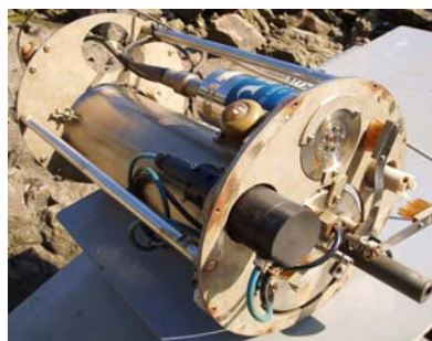
図 5.2-5(3) 鹿跳橋地点水質自動観測装置(操作盤・センサー部・立面図)
