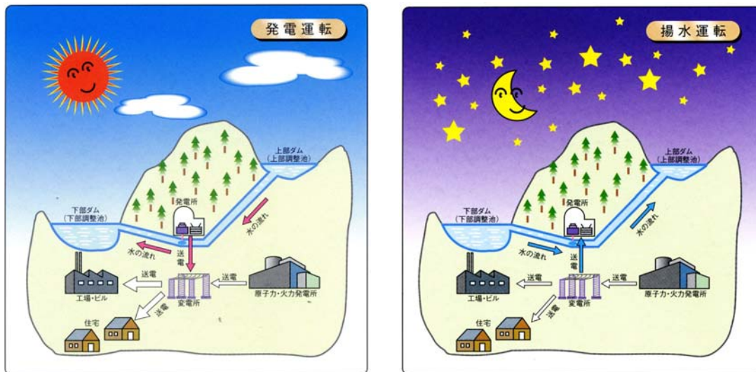
図 3.2-5 揚水発電のしくみイメージ図
