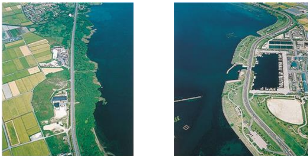
自然前浜と湖岸堤・管理用道路（安曇川地区） 人工前浜と湖岸堤・管理用道路（草津地区）
