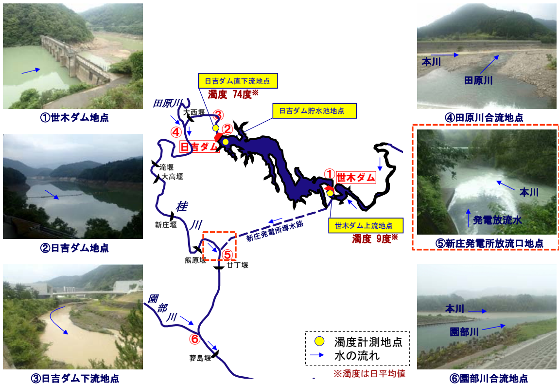
図 5.6.2-19 日吉ダム及び上下流の濁りの状況【平成26年8月14日】
