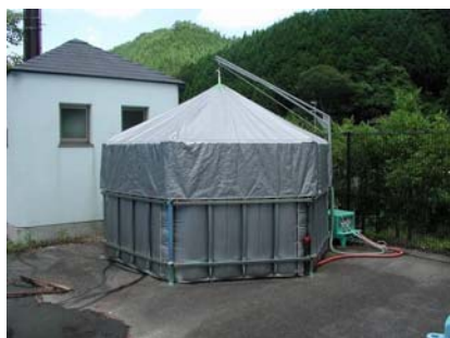
堆肥製造装置 (チップ材発酵中)
