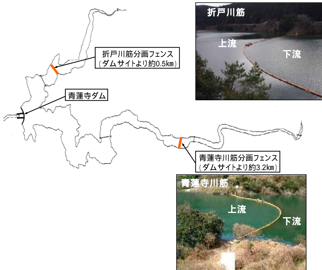
図 1.4.1-4 分画フェンスの設置状況と設置位置
