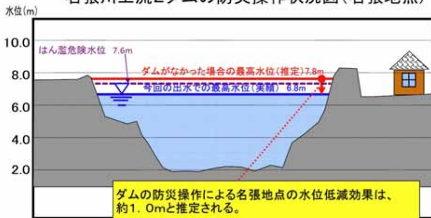
図 2.4.1-12 青蓮寺ダム、比奈知ダムによる水位低減効果
