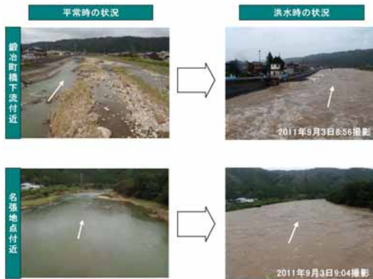
図 2.4.1-7 台風12号における下流河川の水位低減効果
