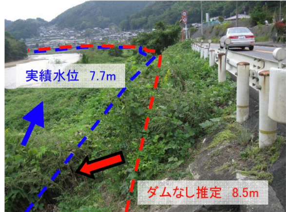
図 2.4.1-4 平成 24 年 9 月洪水（台風 17 号）の水位低減効果【有市地点】
