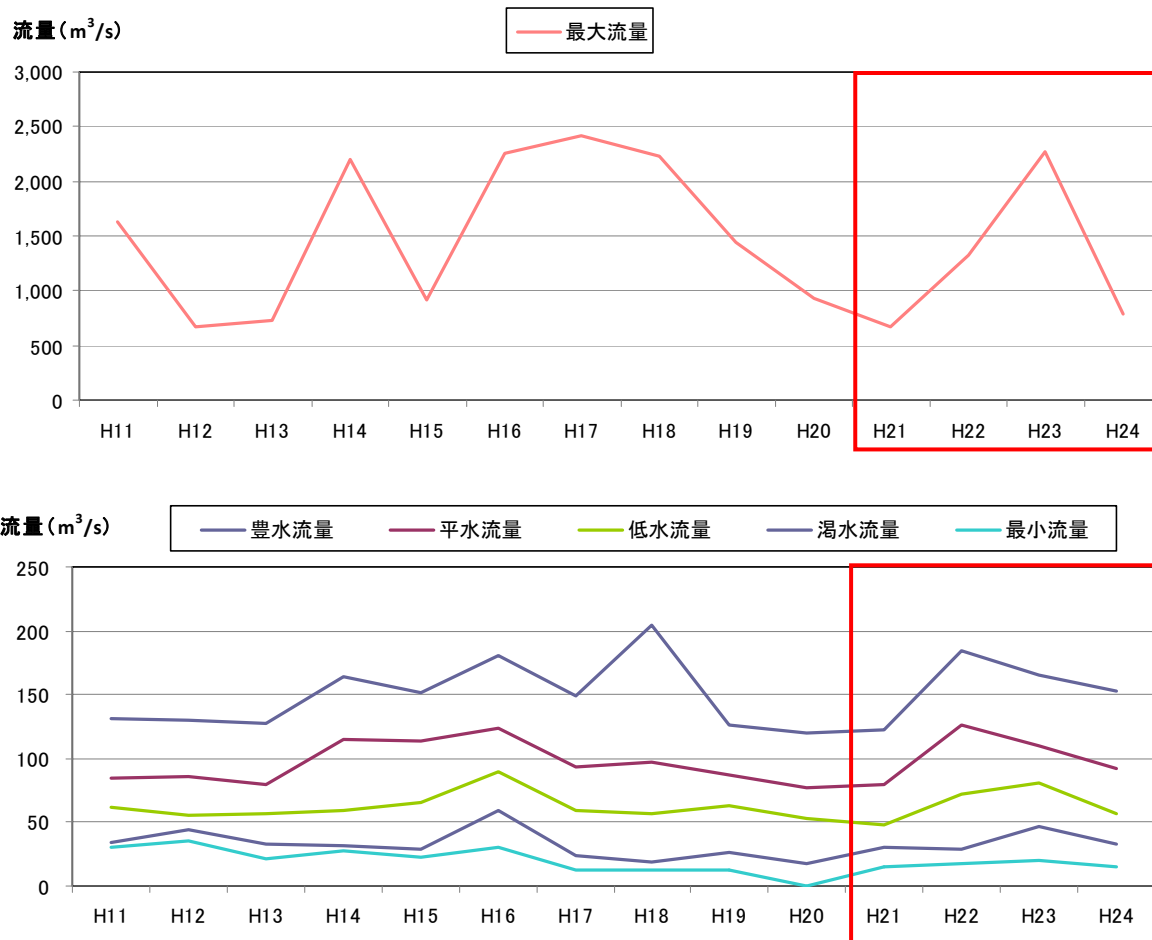
図 5.3-3 鳴鹿大堰の流況推移図
