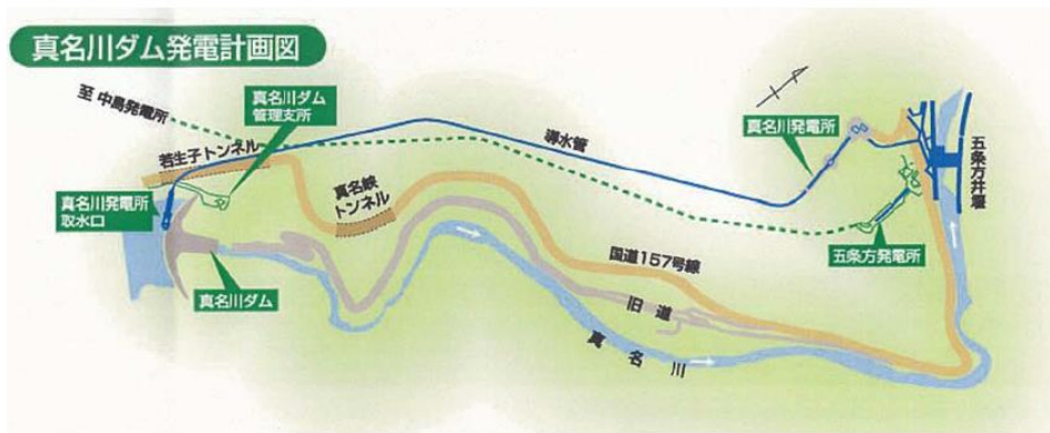
図 3.4-1 真名川ダム発電計画図（無水区間）
