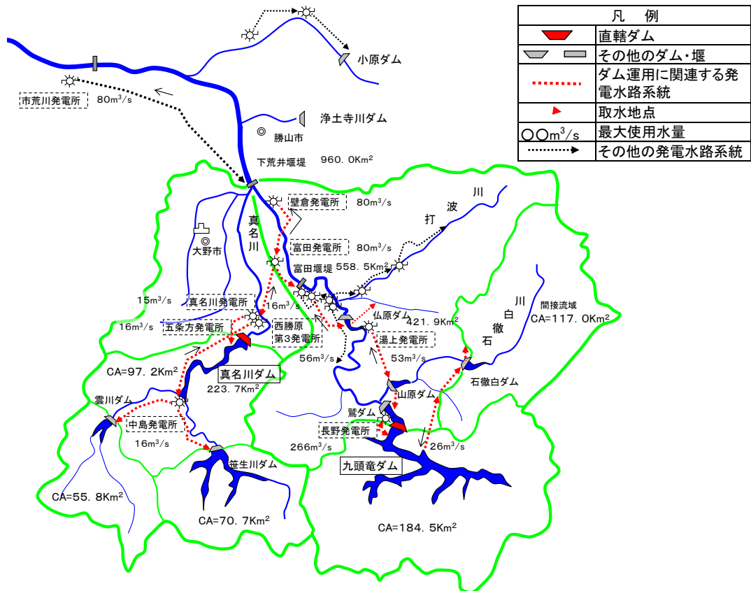
図 1.1-15 九頭竜川中上流域発電利水状況図
