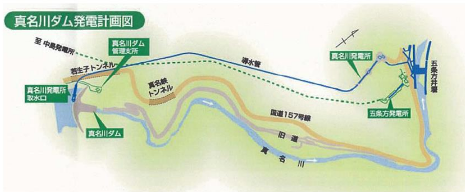
図 3.4-1 真名川ダム発電計画図（無水区間）
