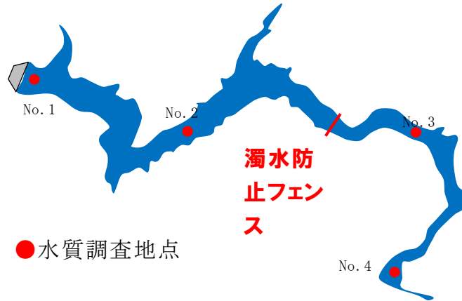
図5.6-5 濁水防止フェンス設置箇所と水質調査地点
