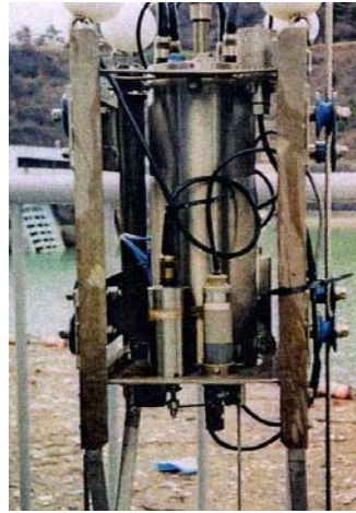
図 5.2-5(1) ダムサイト地点水質自動観測装置(操作盤・センサー部・立面図)
