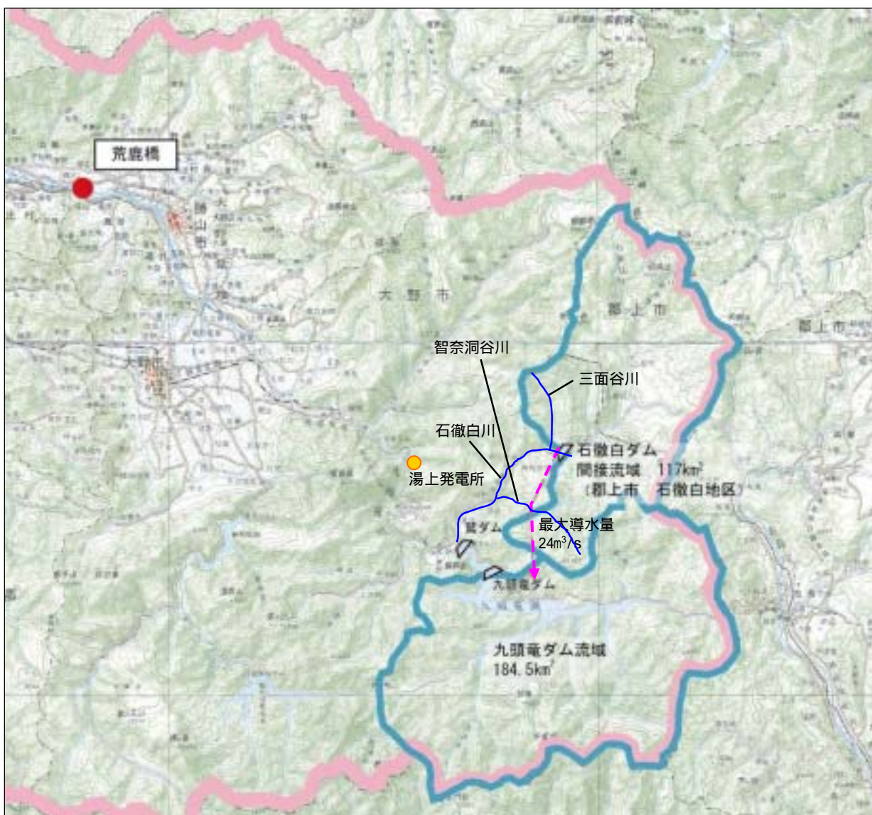
図 5.1-3 九頭竜ダム上流域の状況
