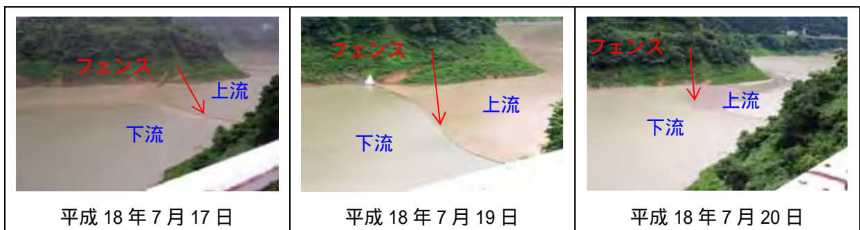
図 5.6-4 出水時の濁水防止フェンス効果調査結果
