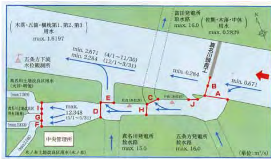
図 1.1 - 13 五条方地点水路詳細図
