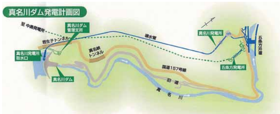
図 3.3 - 1 真名川ダム発電計画図（無水区間）
