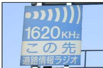
路側放送 道路脇に設置された放送装置により、ラジオから道路情報を発信しています。
