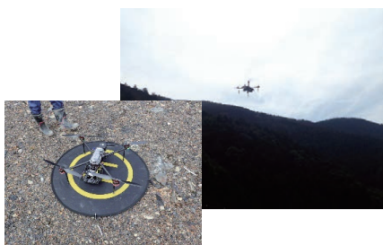
UAVによる 施工前の空中写真測量
