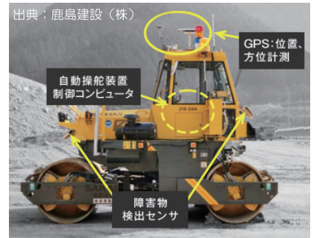
自動化装備を施した重機（振動ローラ）
