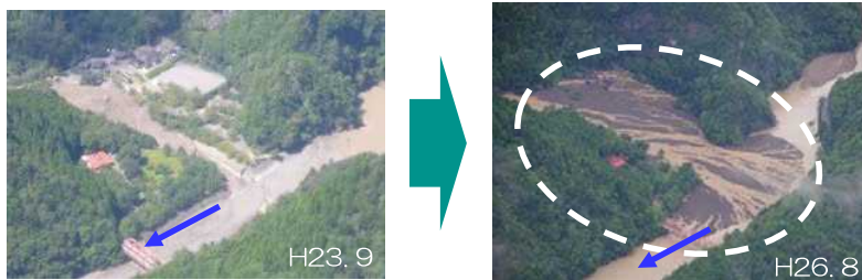
荒廃地からの土砂流出に伴う河床上昇による治水安全度の低下 (赤谷川 川原樋川合流地点 (五條市))
