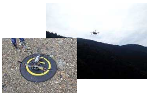
UAV (ドローン) による 施工前の空中写真測量
