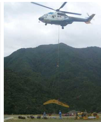
ヘリコプターによる 分解型重機の運搬
