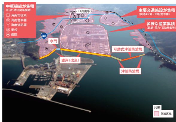
和歌山下津港津波防波堤
