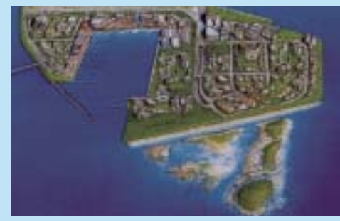
堺泉北港 堺2区地区 干潟（イメージ図） 大和川河口の堆積土を利用し、干潟を造成
