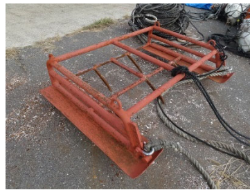
図 63 海底耕耘に用いる桁とその様子
