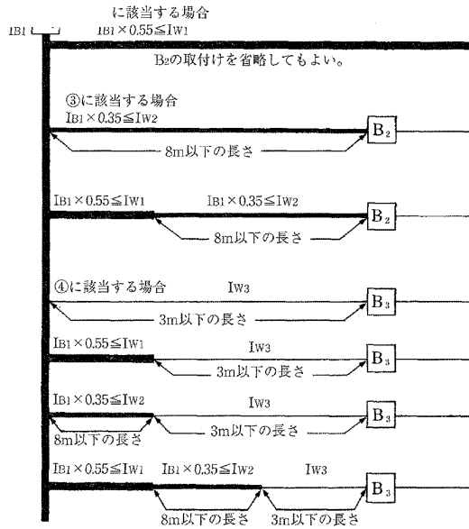
図 低圧幹線の過電流遮断器の施設
