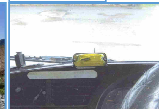
再発防止対策② 運転席警告灯を設置
