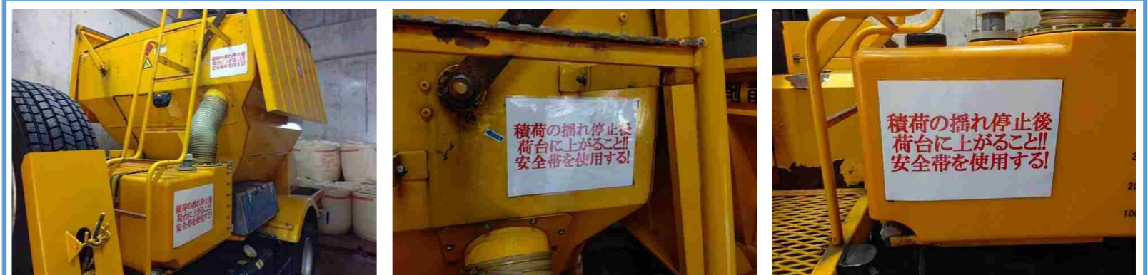
「吊り荷の制止・墜落制止用器具の着用」について分かりやすい場所に注意喚起を明示
