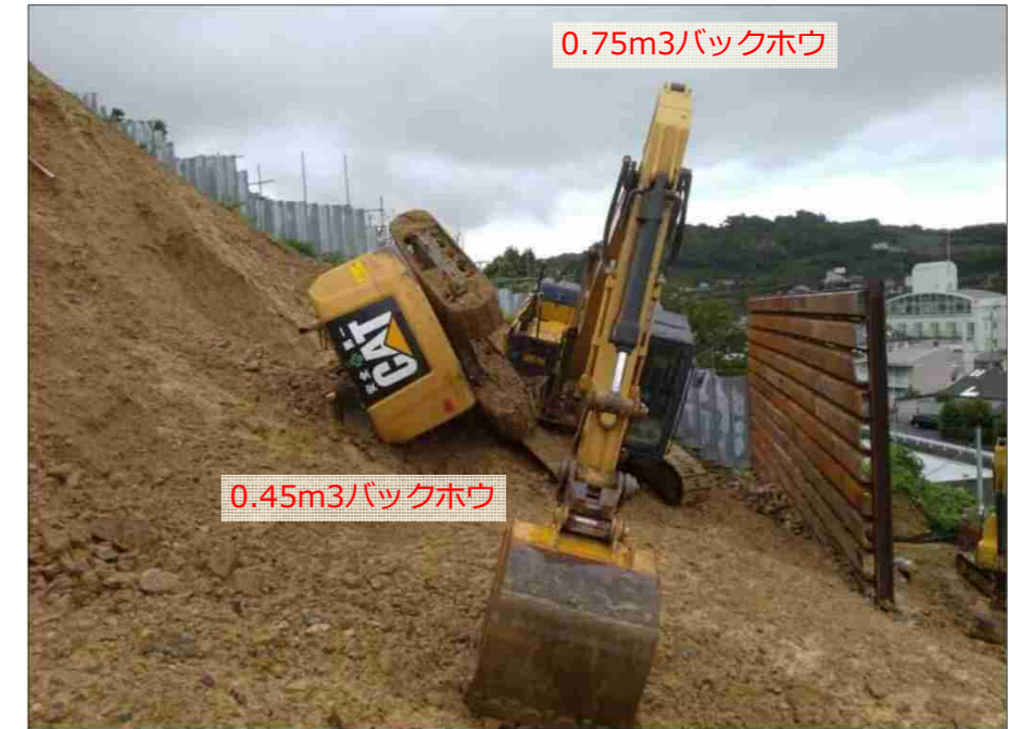
0.75m 3 バックホウへ接触して停止
