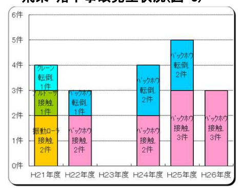
重機の転倒・接触事故発生状況(図-6)
