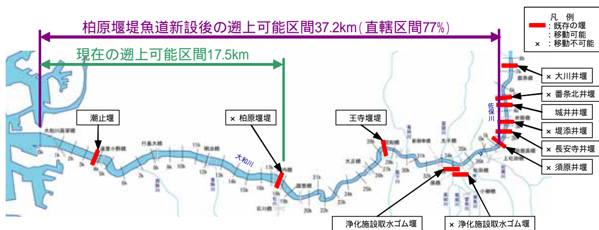
図 3.9 柏原堰堤の魚道の新設による効果
