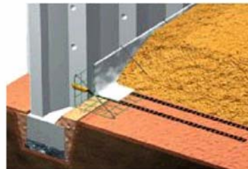
補強土壁(アダムウォール)
