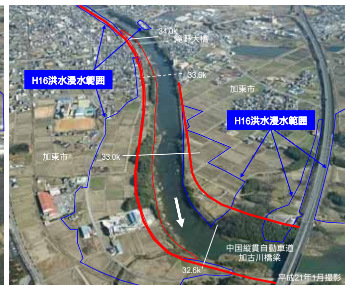
滝野地区 河道掘削・橋梁改築 築堤
