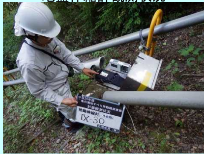
地盤伸縮計観測状況
