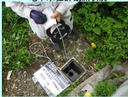
地下水位計観測状況
