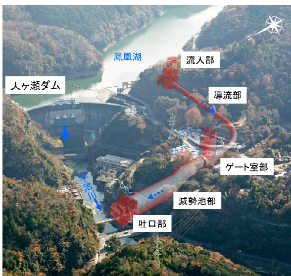
図-1 トンネル式放流設備配置図
