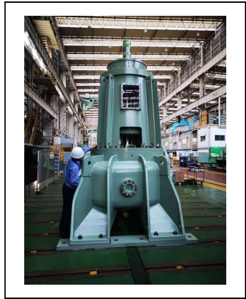
写真-3 呑龍排水ポンプ
