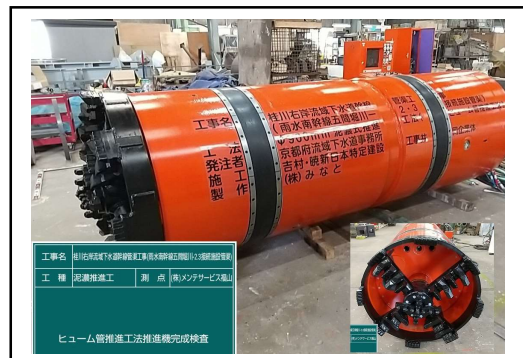
写真-7 推進工掘削機
