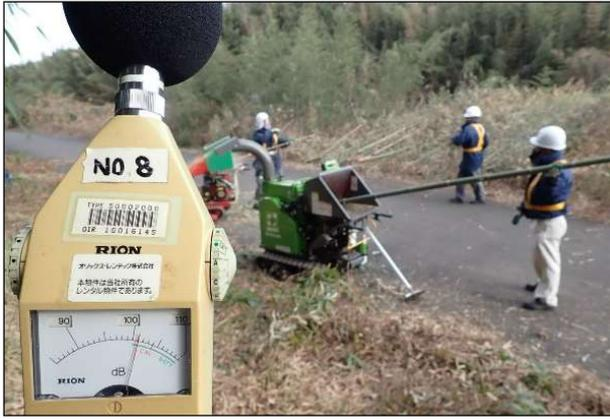
図-11 地元企業による伐採竹のチップ化作業状況
