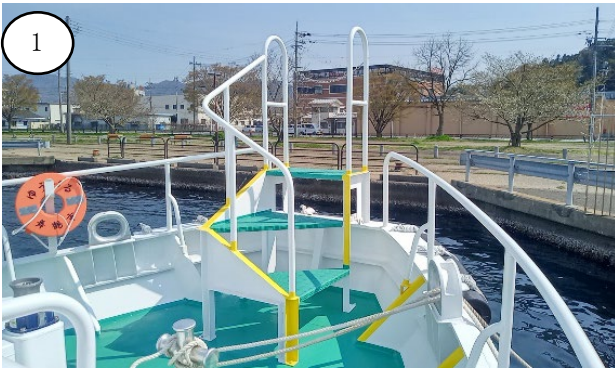
写真3 可搬で着脱可能な昇降台
