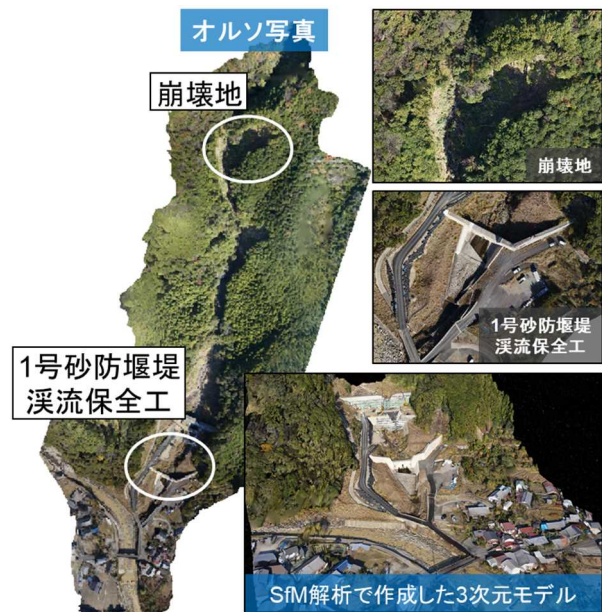
図-7 内の川の溪流全体オルソ写真および3次元モデル
