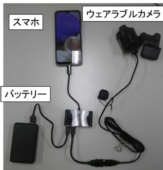
図-11 ウェアラブルカメラの接続状況
