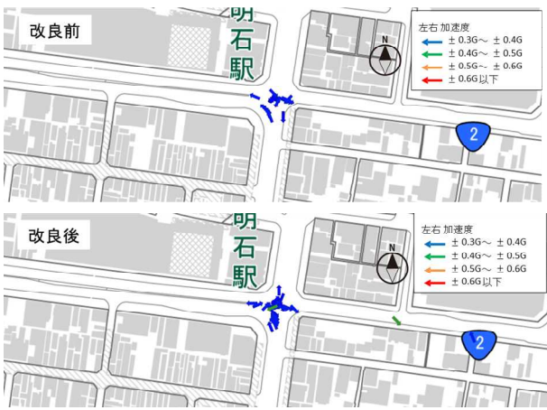
図-11 車両の左右加速度 上図：改良前（2020年），下図：改良後（2021年）
