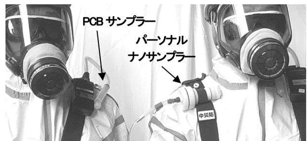
図-4 個人ばく露測定器具の装着状況
