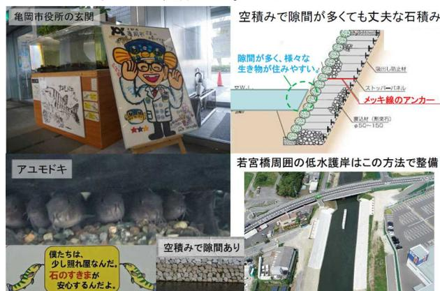
写真-4 市の魚「アユモドキ」と生態系に配慮した低水護岸
