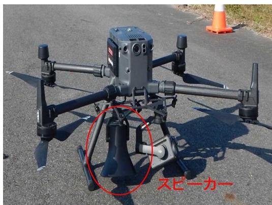
(写真-6 スピーカー搭載ドローン)
