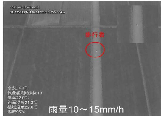
(図-6 降雨時の赤外線カメラ画像)
