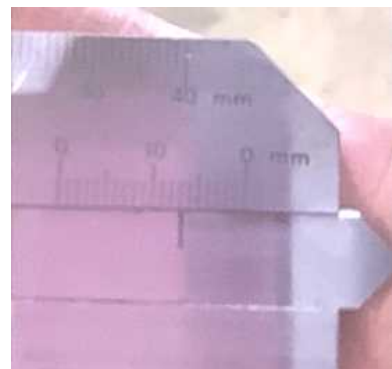
図-7 目盛り確認改善後(溶接ゲージ)
