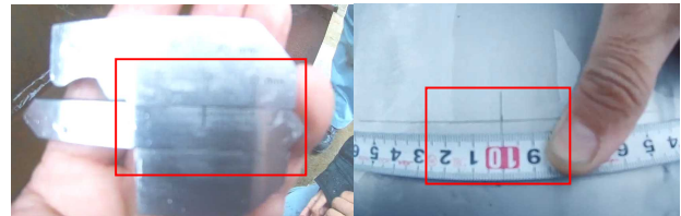
図-6 目盛り確認 (左:溶接ゲージ 右:コンベックス)
