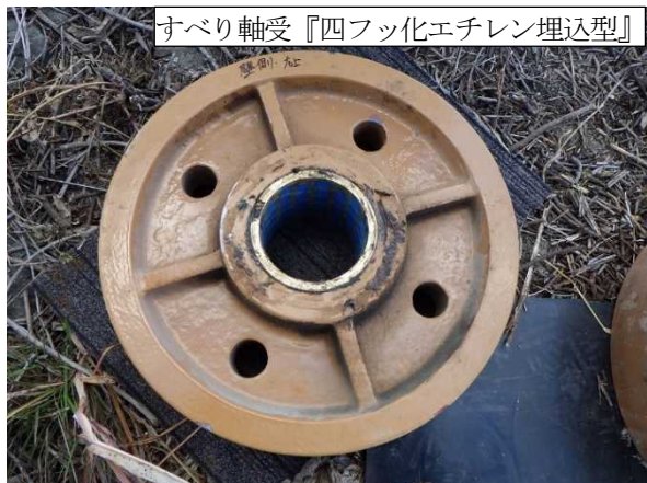
すべり軸受『四フツ化エチレン埋込型』(拡大)
