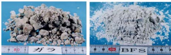
図3 製鋼スラグ（左）、高炉スラグ微粉末（右）
