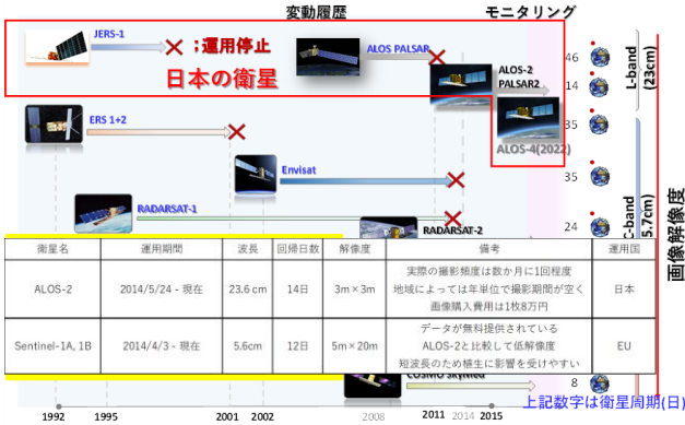
図-3 衛星の詳細及びSAR画像の諸元
