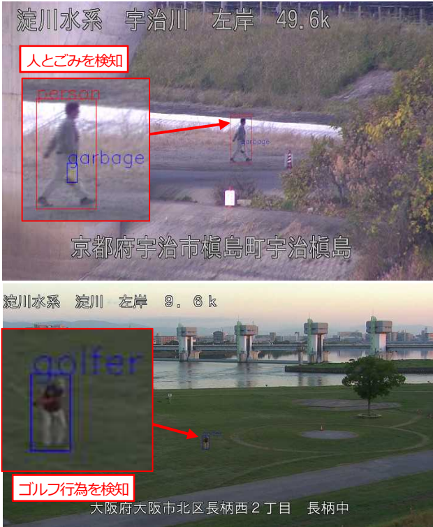
図4-3 CCTV映像の検知結果
