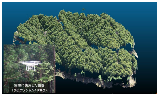
図-2 UAVにより取得した3次元点群データ(SfM)
