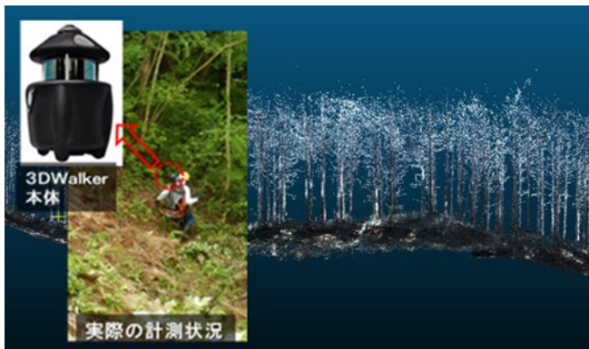
図-1 TLSにより取得した3次元点群データ(LiDAR)
