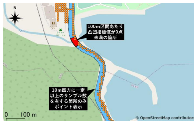
図-11 データ取得可能範囲外の区間の例 （紀南河川国道事務所管内の国道42号）
