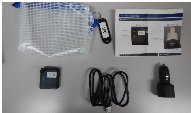
写真-3 除雪車両に取り付けるGPS機器
