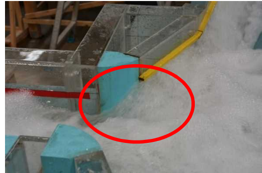
図-21 減勢工接続部の水面変動（右岸接続部） (ケース3)
