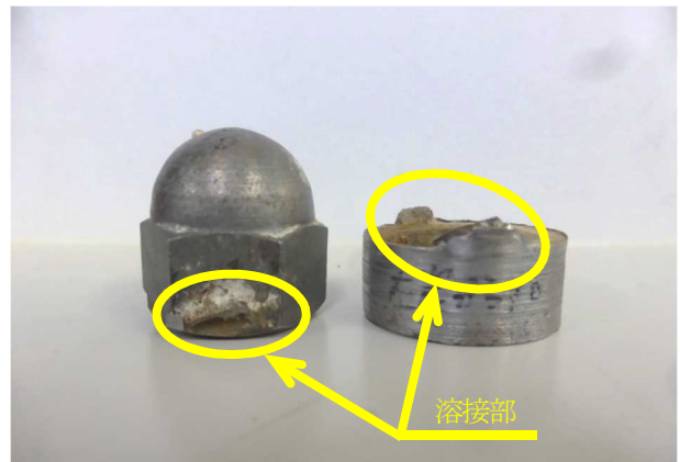
写真2 破断後の袋ナットと敷金物
