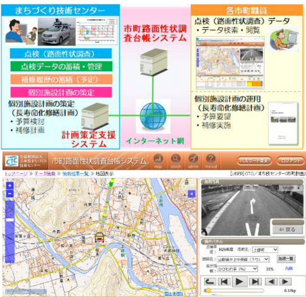
図-12 路面性状調査台帳システムの構成と画面
