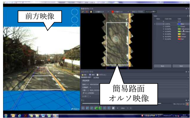
図-7 測定車C ひび割れ解読イメージ
