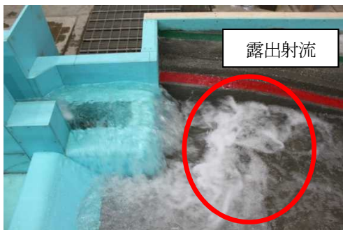
図-13 副ダム下流の流況
