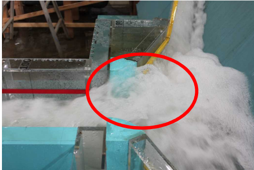
図-19 減勢工接続部の水面変動（右岸接続部）
