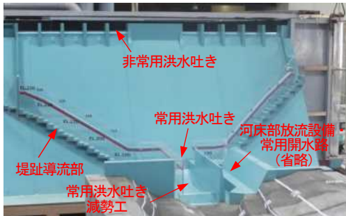
図-5 足羽川ダム本体模型（全体模型）
