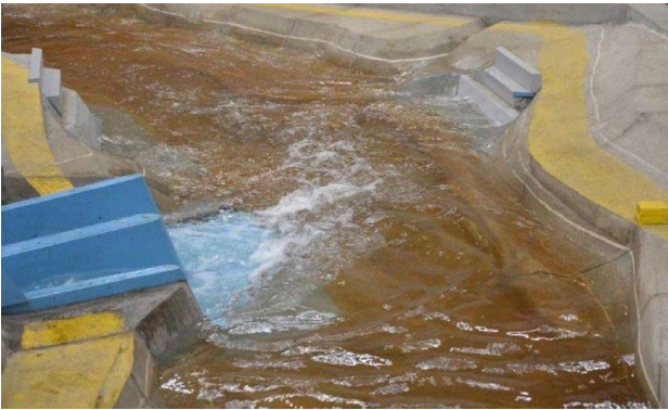
図-6 模型実験による合流形態の検証
