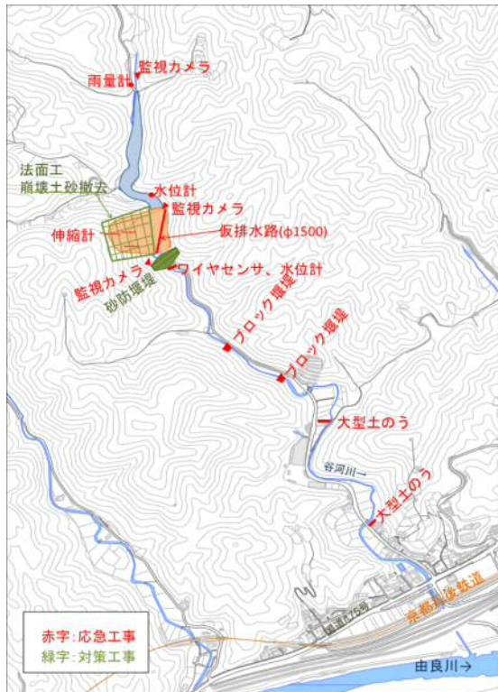
図-10 応急対策工事の概要
