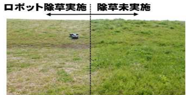
図-11 ロボット除草機による除草作業の様子
