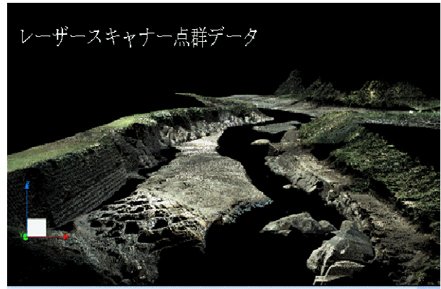
図-2 施工箇所のレーザースキャナ点群データ
