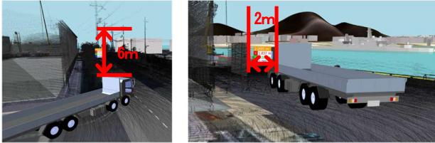
図-15 架空線、既設看板との離隔確認
