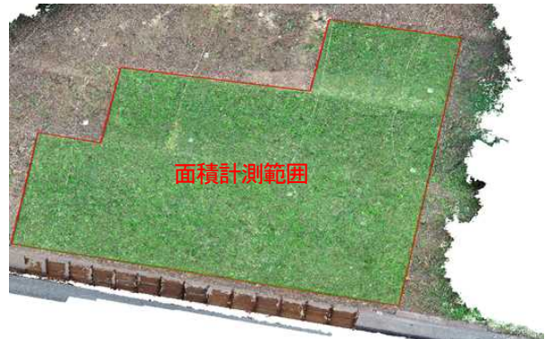
図-7 UAV写真測量による法面面積の計測結果
