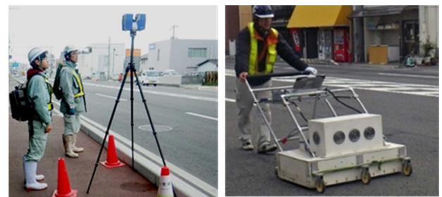
図-2 地上型レーザースキャナ(左)、手押し型アンテナレーダ(右)
