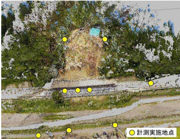
図-13 被災法面における地上レーザ測量
