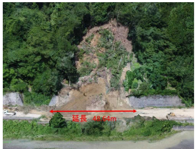
図-12 本県職員撮影写真によるUAV写真測量（距離計測）
