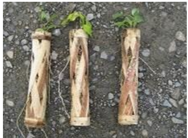
図-5 削岩孔植樹法に用いるキット
