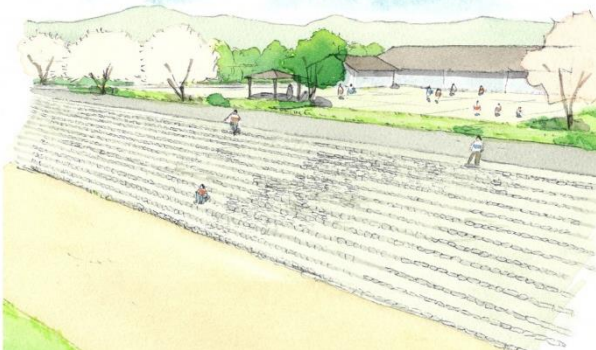
図-6 花火大会等が鑑賞できる階段護岸を整備
